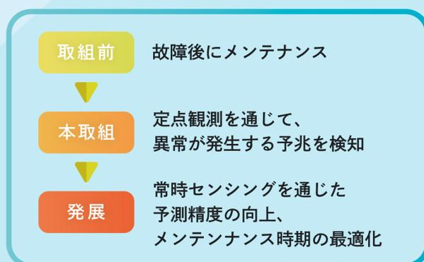
システム化を行うことで、簡易なIoTから、スマートファクトリーで使われるような高度なIoTへとステップアップ！
